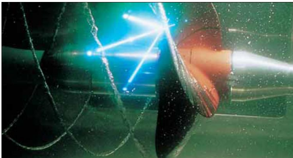
Измерения кавитации вблизи лопастей винта
